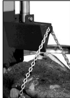
Fahren Sie mit dem Messer so weit nach unten, damit Sie das Holz problemlos anhängen können. Der Stamm muss immer im rechten Winkel zur Maschine liegen und an der Maschinennahen Seite angehängt werden. Dazu müssen die Haken links und rechts in das Holz geschlagen werden. Anschließend wird die Kette am herabgefahrenen Messer eingehängt. Dazu befindet sich an der Messervorderseite ein kleiner Haken an dem die Kette mittig eingehängt wird.
